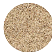
【吸収材の中身】 きめの細かいパーミキュライト粒子が液体を逃しません。
