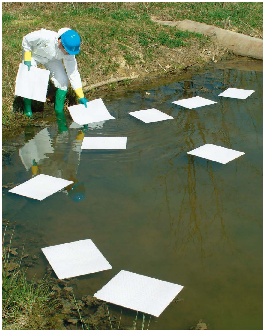
ピグ ® の油専用マットは飽和状態になっても水の上に浮かんでいます。
