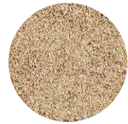
【吸収材の中身】 きめの細かいパーミキュライト粒子が液体を逃しません。
