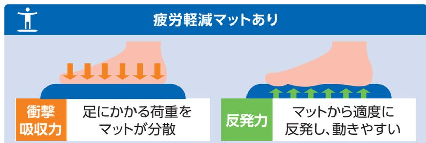
〈疲労軽減マット〉は、マットの「衝撃吸収力」で集中的にかかっていた荷重を分散し、適度な「反発力」で足が動かしやすく、立ち作業を快適にサポートするので疲労軽減につながります。
