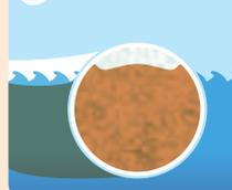
完全に飽和状態になると、重みによって少し沈み、水面に浮く面積が小さくなります。この状態になったらブームを交換してください。吸収された油は漏れないので、容易に回収することができます。
