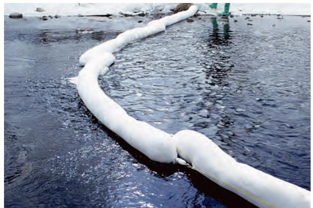
水を吸収しないので水面でも沈むことなく、油だけを吸収
