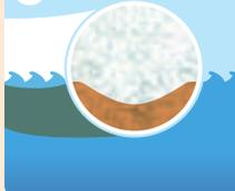
水面の油漏れにブームを設置すると水面に浮いた油のみを吸収しはじめます。油を吸収した分のブームが、水中に沈みます。
