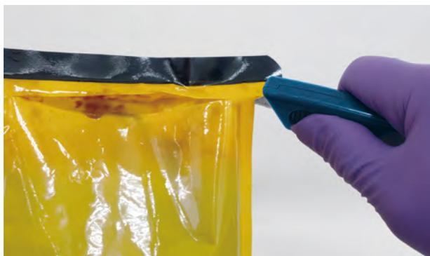
刃を突き刺し一回で切ることで、パウチなどのカット時に破片が出にくい
