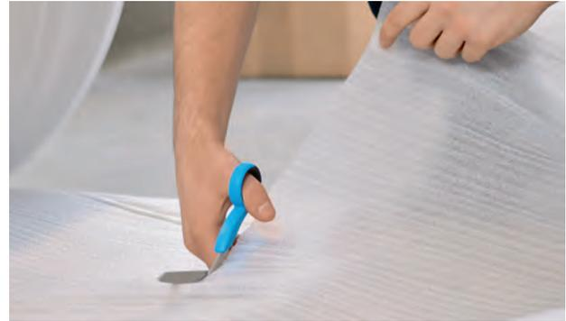
刃先が丸いので、刃の先端による切創事故を防止
