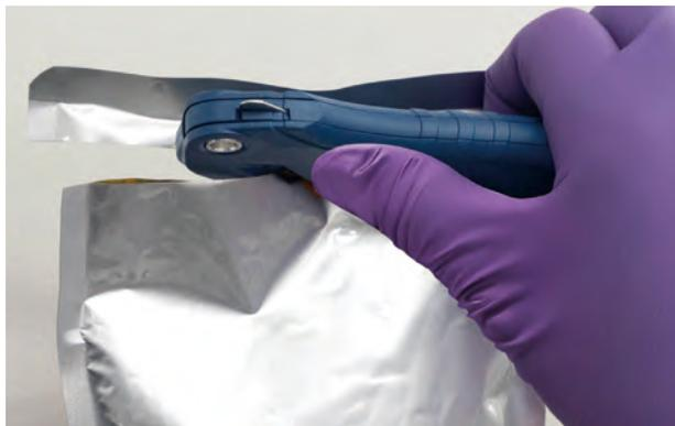
挟み込み一回で切ることで、パウチなどのカット時に破片が出にくい
