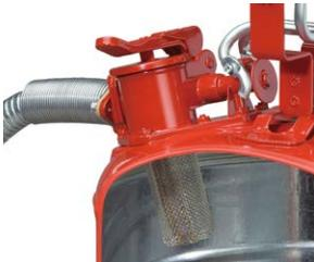
注入口の2重のメッシュ構造のステンレス製フレームアレスター（消炎金網）は、熱を拡散して逆火や爆発を防ぎます。細かいメッシュと粗いメッシュが混合した2重のメッシュ構造は、注入に影響を与えることなく、火気を防止します。
