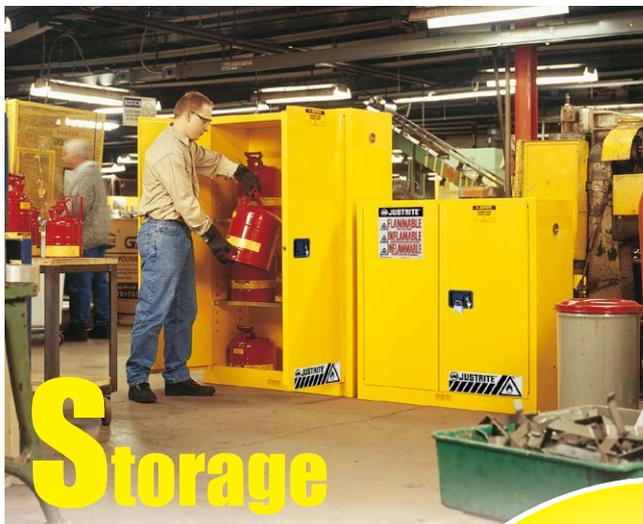
揮発性液体を安全に保管し、火災や爆発のリスクを低減します。また、作業現場の近くに揮発性液体を安全に保管することができ、作業効率が上がります。
