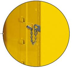
付属のリングを使用して扉を開いておくことができます。火災などの発生の際は、約74℃でリングが溶け、自動的に扉が閉まります。(セルフクロースタイプのみ)
